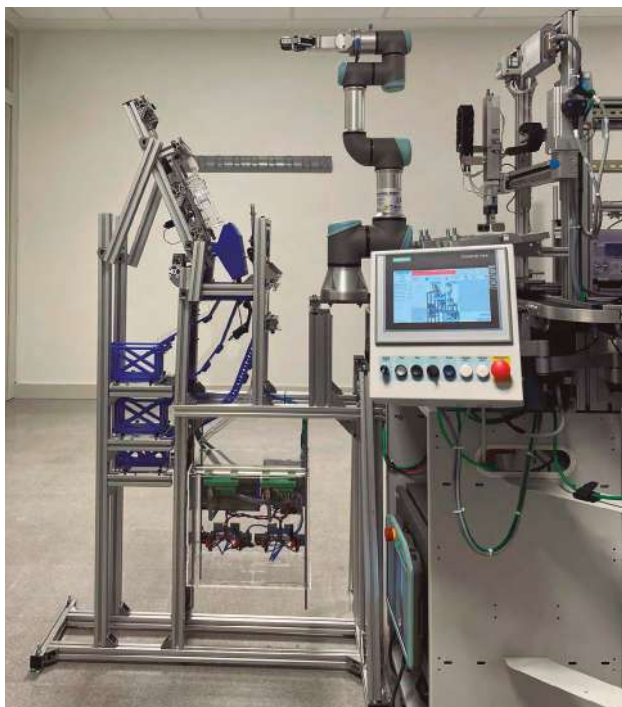
PFM de Jon Muñoz Milikua: Imagen de la estación automatizada para desensamblaje
