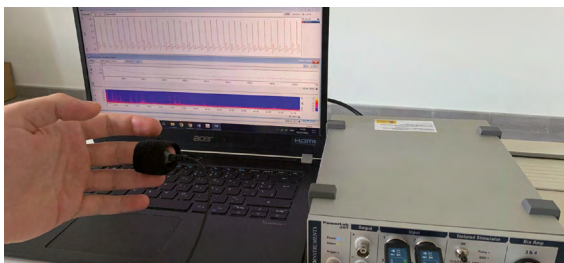
Visión completa del sistema de monitorización de la frecuencia cardíaca en tiempo real mediante el transductor de pulso dactilar con PowerLab
